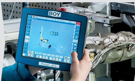
Mobilni 10-palčni upravljalni terminal s kablom, tipko za zaustavitev v sili in dovolilnim stikalom.
